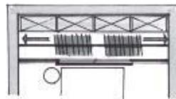
2 Hängegleiter in 1 Deckenschiene vor dem Regal unter einer Dachschräge
